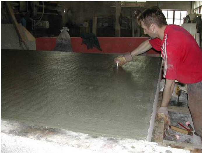
Figure 31 : Mise en place des dispositifs pour le transport de la structure.
