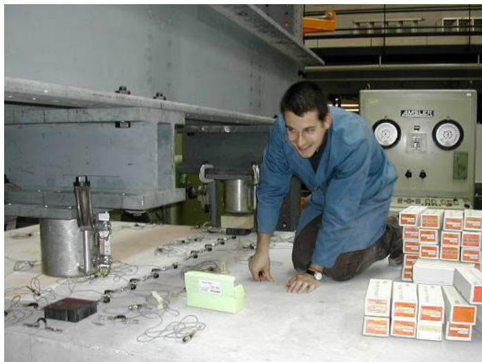
Figure 39 : Installation des jauges oméga.
