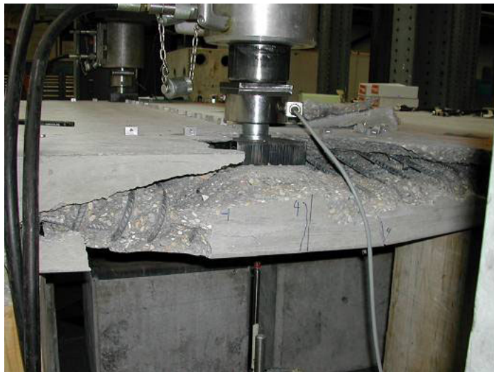
Figure 65 : Cône de poinçonnement (après nettoyage).
