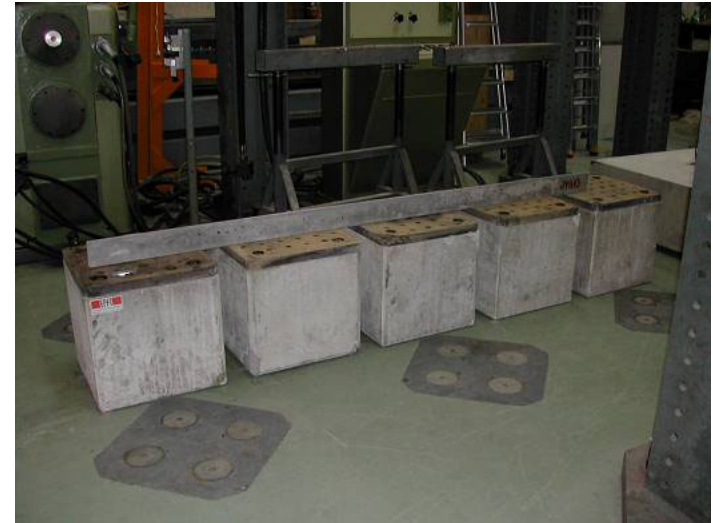
Figure 34 : Calage des 5 blocs de fondation.
