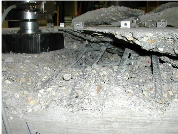
Figure 64 : Armatures de flexion après poinçonnement.
