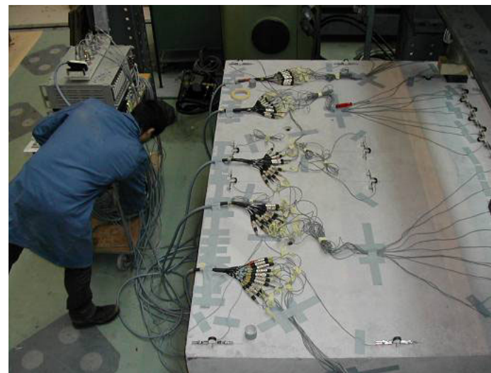
Figure 42 : Groupement des câbles pour chaque port de l'UPM.
