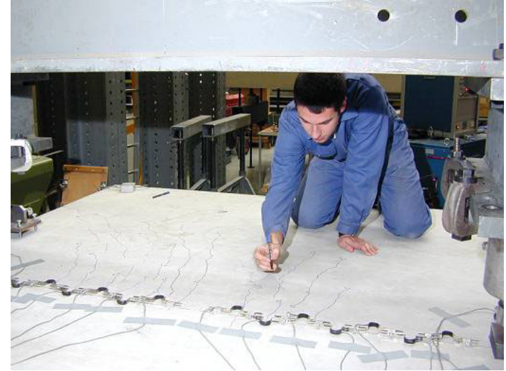
Figure 60 : Marcation des fissures sur la dalle.
