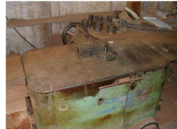
Figure 9 : Machine pour le pliage des armatures.
