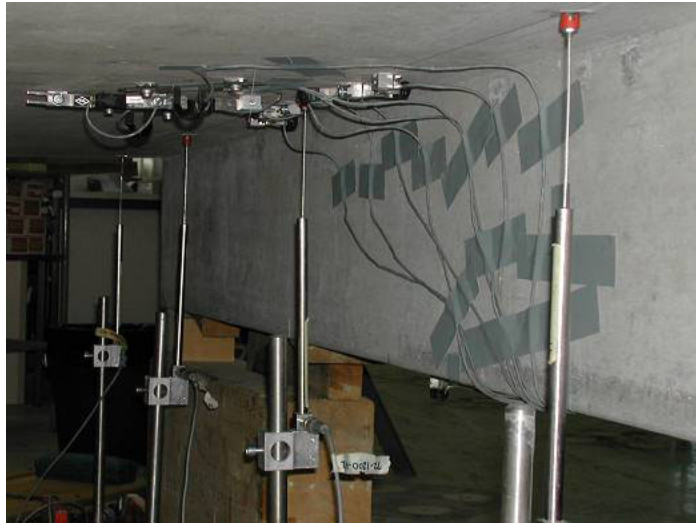
Figure 43 : Jauges oméga, capteurs inductifs et câbles rangés.
