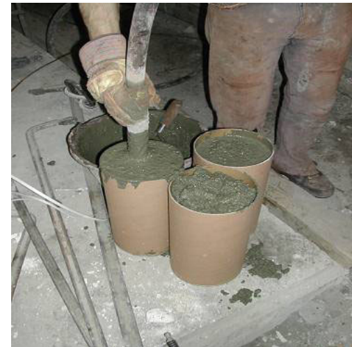
Figure 29 : Vibration du béton dans les cylindres pour l'essai à la compression.
