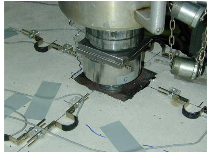
Figure 38 : Vérin et capteur de force sur plaque en acier (après rupture).
