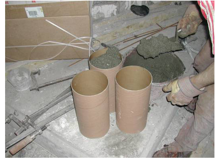
Figure 28 : Remplissage des trois cylindres pour l'essai à la compression.
