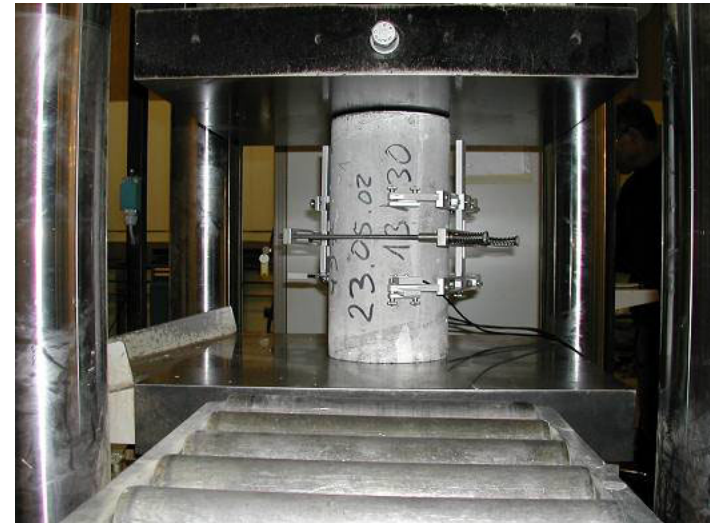
Figure 66 : Essai d'éprouvette pour la détermination du module d'élasticité.
