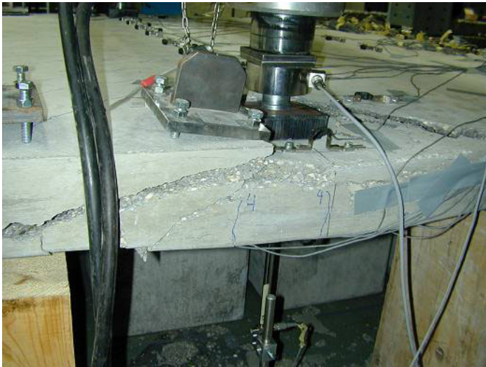
Figure 61 : Rupture par poinçonnement.
