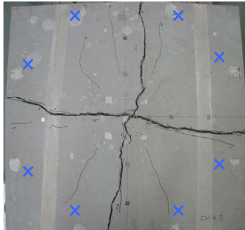
Figure F.6: Lignes de rupture dans une dalle mince essayée en flexion ([Spasojevic 2008], fig. 6.14b) Yield lines in a thin plate tested in bending ([Spasojevic 2008], Fig. 6.14b) Fliesslinien bei einer dünnen Platte, getestet unter Biegebeanspruchung ([Spasojevic 2008], Fig. 6.14b)
