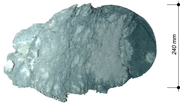
Fig. 6.38 : Manque des fibres sur la section de rupture de l'échantillon S1
