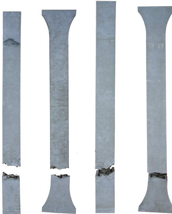
Fig. C.29 : Images des quatre côtés de l'éprouvette à la rupture
