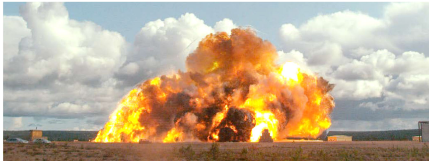
Figure 2. Boule de feu et onde de choc 24 millisecondes après la détonation lors de l'essai SHIELD en 2019.
