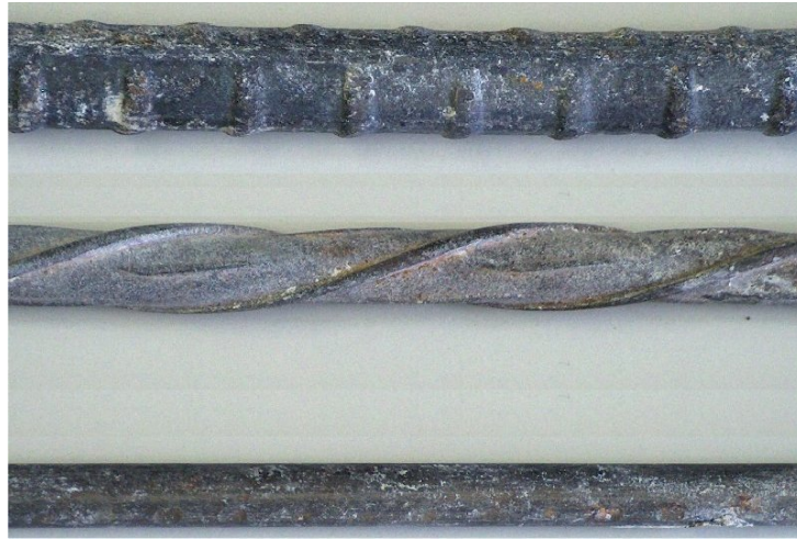
Figure 2.25: Armature (du haut en bas) : acier passif "Box" (dalle de roulement), acier passif "Tor" (éléments préfabriqués), acier de précontrainte "1500/1700" (éléments préfabriqués)
