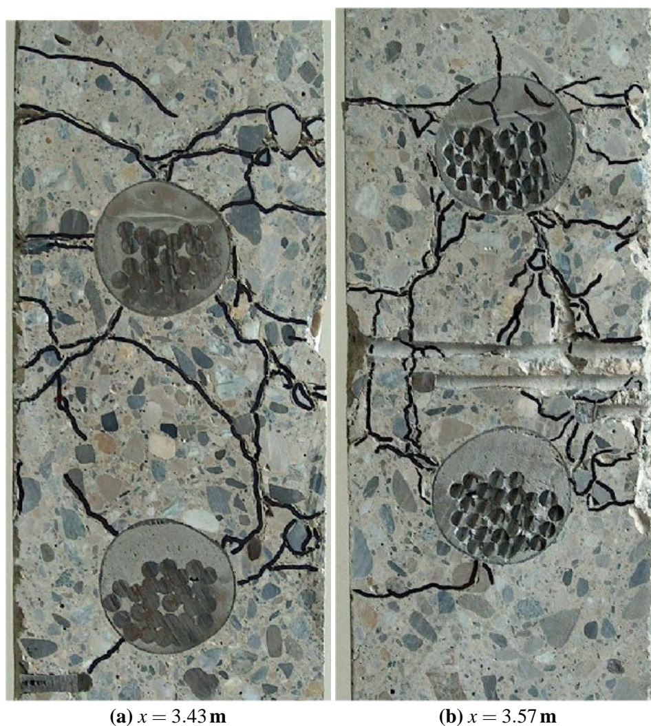
Figure 4.16: Essai SH3 : fissuration interne autour des câbles dans la partie Sud avec effort tranchant maximal ; coupes effectuées après l'essai
