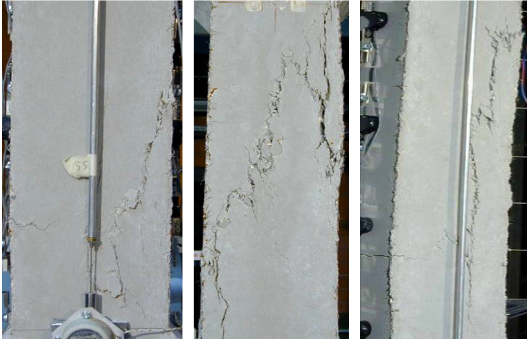
Bild 21: Unterschiedliches Bruchverhalten aufgrund der axialen Vorbelastung und der Bewehrungsart; (a) kleine Axiallast, unbewehrt, (b) mittlere Axiallast, bewehrt, (c) grosse Axiallast, vorgespannt.
