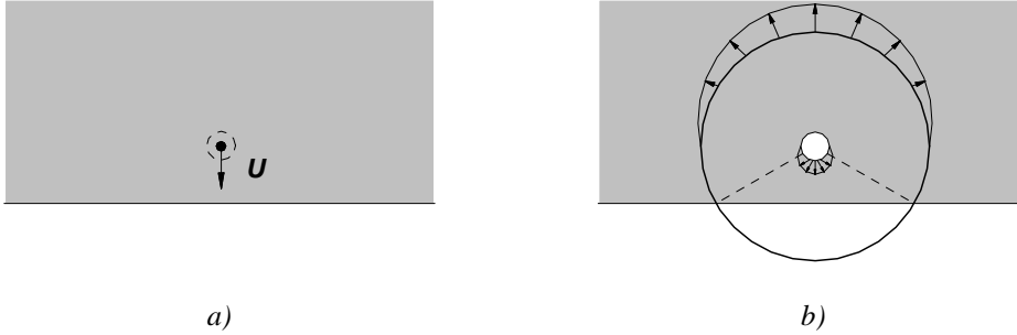
Figure B.7: Hypothèses pour le calcul de la pointe de contrainte au droit de la barre d'armature: a) modèle du plan semi-infini selon Franz, Fein 1971 et b) modèle de l'anneau selon Neuner 1983
