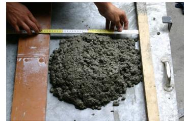
(c) Exécution du test d'étalement
