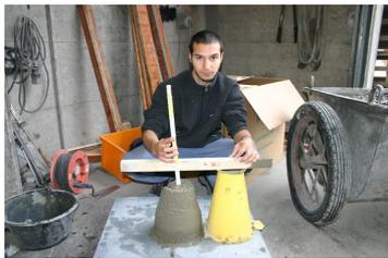
(d) Exécution du test d'affaissement
