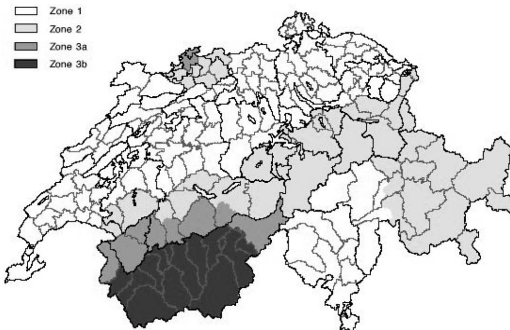
Figure A.2.3. Nouvelle zonification sismique [SWISSCODE 2003]
