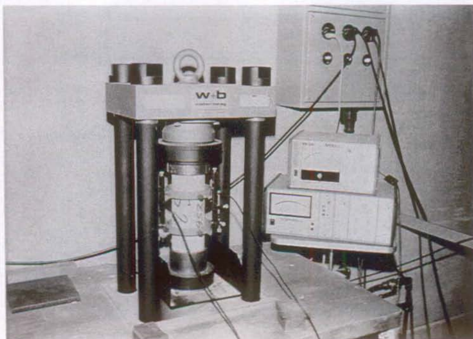
Figure 2.4: Stand d'essai pour la mesure du module d'élasticité (laboratoire LMC)
