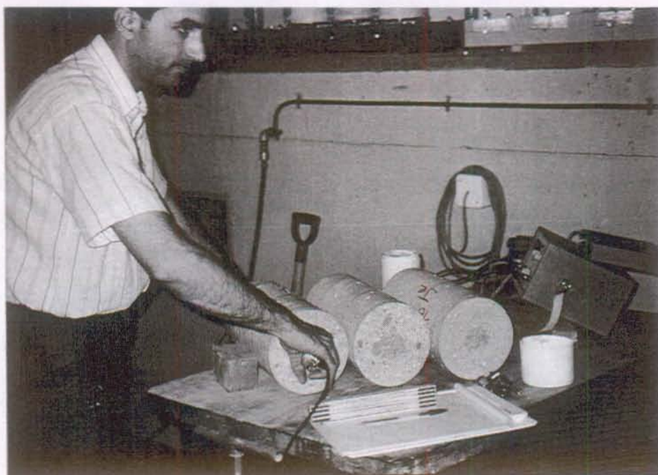
Figure 2.7: Mesure de la vitesse du son dans une éprouvette en béton au moyen de l'appareil de mesure PUNDIT
